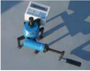
1 下地塩ビにビス引抜試験
