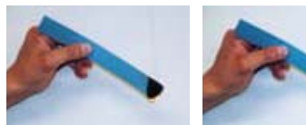
▲サンタックIBシートに着火した状況
