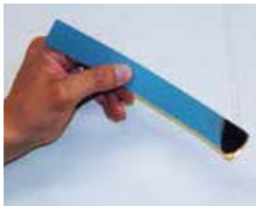
▲サンタックIBシートに着火した状況
